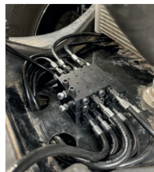
Centralsmörjning för framaxel och frontlyft på S-serien.
