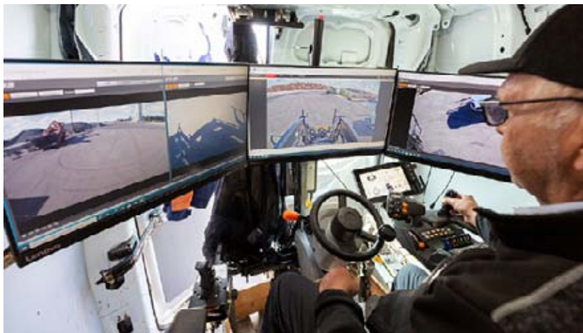
Här styrs traktorn från en skåpbil. Det går även att fjärrstyra en traktor med reglage i en annan traktor, eller mer begränsat via en portabel styrenhet.
