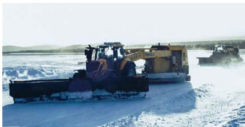
Här styrs traktorn från en skåpbil. Det går även att fjärrstyra en traktor med reglage i en annan traktor, eller mer begränsat via en portabel styrenhet.
