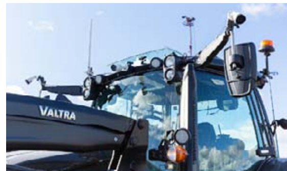
Kameror monterade på utsidan visar föraren vad som händer runt traktorn.
