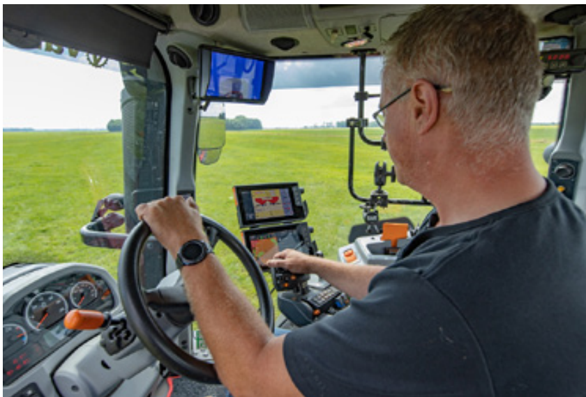
En andra SmartTouch-skärm gör att Thijssen kan visa data från traktorn och anslutna Isobus-redskap samtidigt utan att svepa över skärmen. All data och alla inställningar för traktorn och redskapet är inom räckhåll. Skärmen längst upp är från en övervakningskamera.
