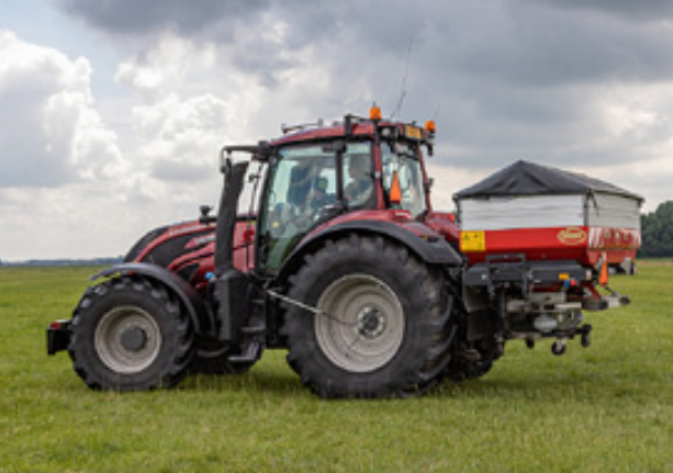
För att få det lägsta marktrycket har Thijssens Valtra T174 Direct Michelin XeoBib-däck med däcktrycks kontroll.
