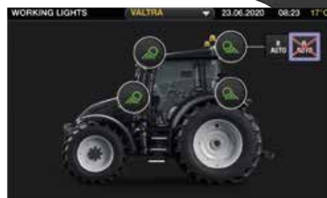
Arbetsbelysningen ställs in snabbt och enkelt via den 9-tums pekskärmen. Praktiska på- och av-knappar för arbetsljus och varningsljus finns lättillgängliga i armstödet.
