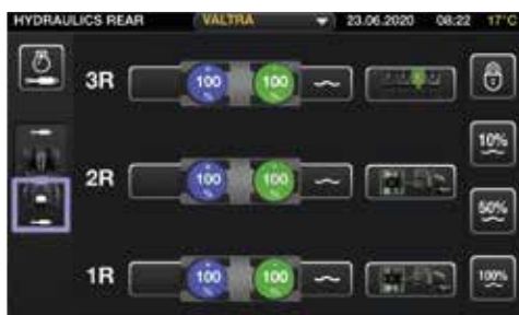
Du väljer själv vilket reglage som styr vilken hydraulisk funktion, fram, bak eller på frontlastaren.
