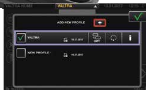
Skapa profiler för både förare och redskap som enkelt kan ändras från valfri meny. Alla justeringar sparas automatiskt i den valda profilen.
