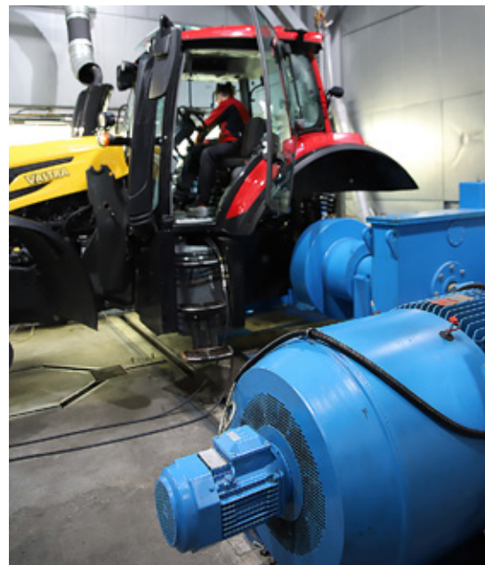
Jan-Erik Karjula kör en traktor på testbädden. Resultaten kommer att användas för att vidareutveckla både traktor och simulator.
