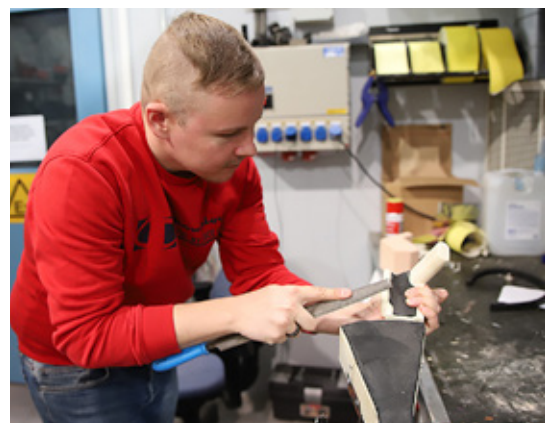
Industriedesignern Henri Hokkanen arbetar på en plastmodell av ett armstöd. En hel del plast, trä och 3D-tryckta komponenter används i designstudio för att göra fullstora modeller av framtida traktorer och hytter.
