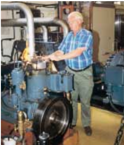
Sven Arnegård förvärmer, med blåslampans hjälp, en tändkulemotor.
