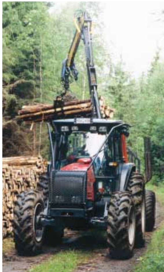
Ett proffsigt skogsekipage. En Valtra HiTechtraktor med rätt utrustning kan i många fall konkurrera med specialmaskinen.
