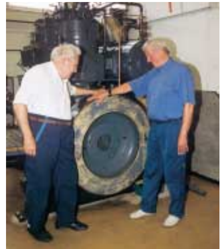
Denna tvåcylindriga marinmotor är på hela 58 liters cylindervolym. Enbart svänghjulet väger 900 kg. "Gubbarna" är två av trotjänarna i Munktells-museet. Sven-Gunnar Jonsson, t.v. började på BM 1939, och Per Engström började 1945.
