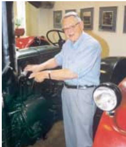
Nils Kassling pekar på BM 10:ans kylfläkt. Den sitter bakom motorn och längs med traktorkroppen. På de tjugotalet först byggda "små BM-arna" drevs fläkten med hjälp av dubbla vinkelväxlar. Dessa byggdes senare om till det slutliga utförandet med remdrift.
