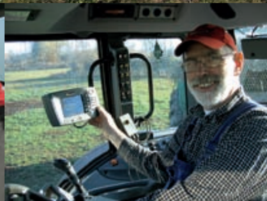
– Autoguiden är enkel att hantera. Det är bara att ställa in start- och slutpunkt på fältet samt bredden på redskapet. Sen styr Auto-Guide efter virtuella körspår som täcker hela åkern, berättar Anders Watz som driver Husby Gård tillsammans med sin son.
