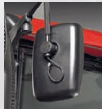
De elektroniskt ställbara och uppvärmda backspeglarna förbättrar sikten och säkerheten.
