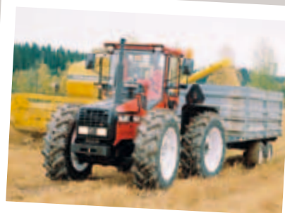
Valmet 800 hade en helt hydrostatisk transmission.
