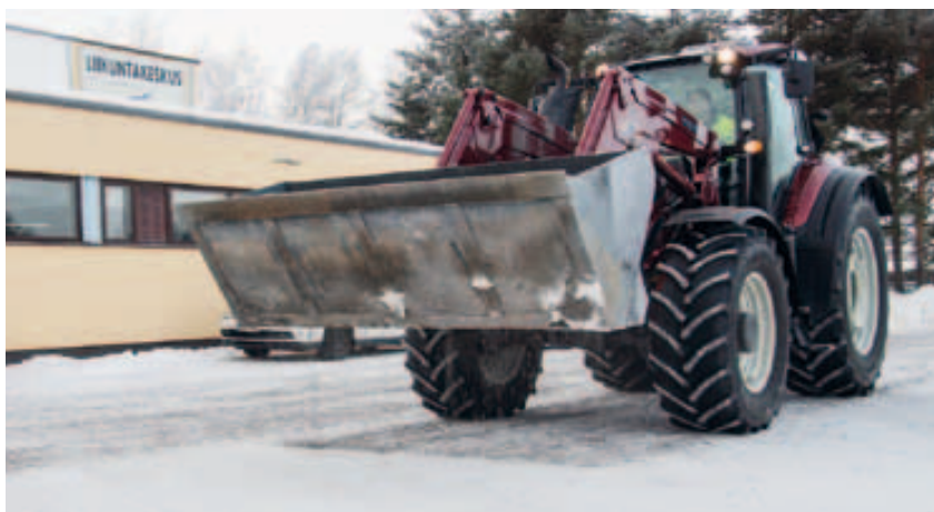
Kokkos T174 Direct har jobbat början av året särskilt med vägunderhåll. Simhallens och idrotts husets gårdsplan får ett jämnt sandlager mot halkan.
