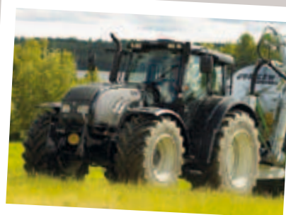
Med Valtra T202 Direct lanserades dagens steglösa transmission, som är en kombination av mekanisk och hydrostatisk överföring.
