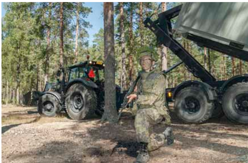
Traktorerna har visat sin mångsidighet i Försvarsmaktens tjänst. Med dem kan man lasta på och av gods i skogsterräng samt dra containrar som väger till och med 16 ton och hantera dem med växlavagnar. Dessutom plogar traktorerna vägarna förutom för sig själva även för andra fordon.
