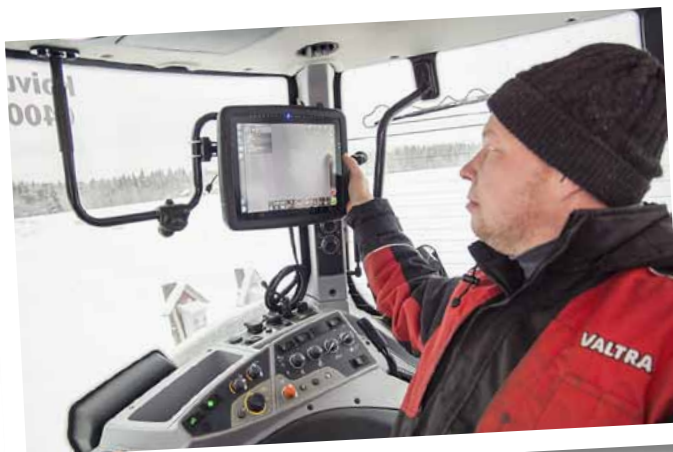
Tero Koivuranta odlar potatis i Karijoki. T214 Directs autostyrning är till hjälp vid användningen av kupfräsen, skördebärgning, plöjning och nästan alla andra arbeten. Autostyrningen för traktorn med ett par centimeters precision.
