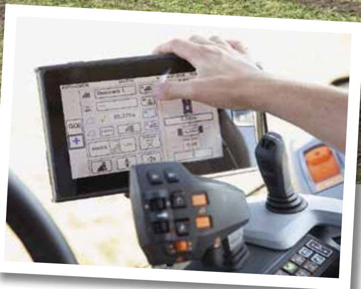
Auto-Guide-automatstyrningen är en viktig del i DanRoots odlingskoncept. Traktorerna och skördemaskinerna går precis på samma körspår.
