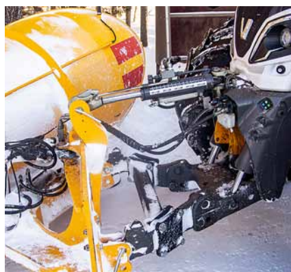
Haasala Oy tillverkar plogstöd för mellan lyftarmarna i frontlyften till fjärdeseriens Valtror. Stödet förhindrar lyftarmarna från att vrida sig, om man med plogen krockar med ett brunnslöck eller motsvarande hinder. Stöden säljs genom AGCO Suomi.
