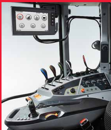
Vänster: En motsvarande skärm som i SmartTouch-modellerna fås nu också till N- och T-seriens HiTech- och Active-modeller. Med skärmen kan man ta i bruk precisionsodlingsegenskaper, såsom AutoGuide-automatstyrningen.
