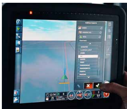
AutoGuide-automatstyrningen för traktorn på banan med 6–12 millimeters precision.
