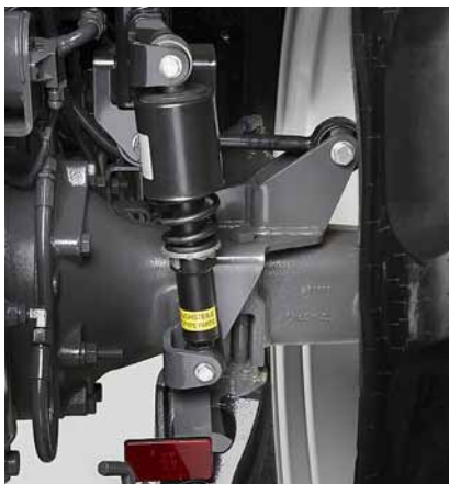
Den mekaniska hyttfjädringen är reglerbar och stabiliserad med två Panhard-stag.
