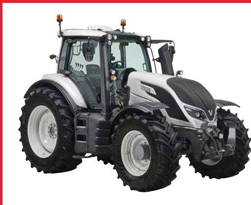
Nya T- och N-seriens modeller känns igen på det ännu smalare avgasröret, som förbättrar sikten framåt mot höger.
