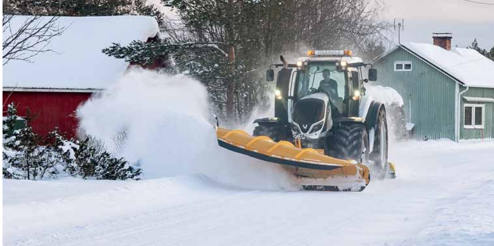
T234 Versu plogar en byväg med Vuomets plog, isvallen försvinner med hyvelstift bakpå traktorn. Traktorn är Finland 100-jubileumsårets modell, med nummer 16. I Lochteå för den från havet blåsande vinden lätt snön tillbaka på vägen.
