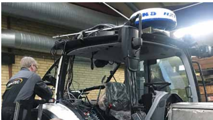
Valtra N154 är en multiarbetsmaskin, på vilken man kan montera olika redskap såsom marinradar, infraröd värmekamera och strålkastare.
