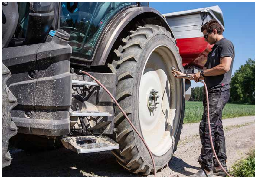
Till den nya G-serien kan man som tillval få uttag för tryckluft vid stegen till hytten. Praktisk för renblåsning eller om man behöver justera luftrycket i däck.
