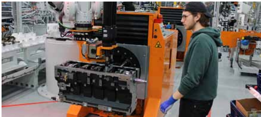
Mekanikern Julius Salmela monterar en vevaxel med hjälp av en industrirobot.
